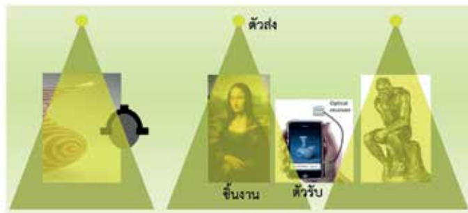
รูปที่ 1: ลักษณะการใช้งานของระบบส่งข้อมูลผ่านหลอดแอลอีดีส่องสว่างสำหรับการจัดแสดงนิทรรศการ
